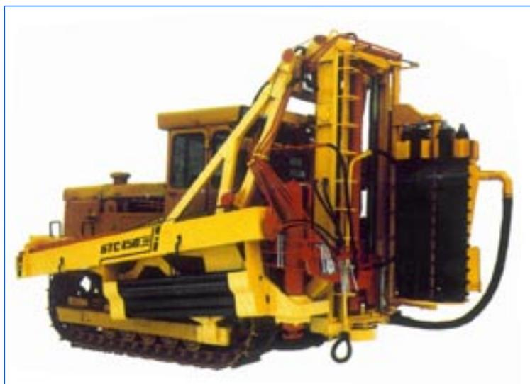
Предназначен для бурения взрывных вертикальных и наклонных скважин в скальных породах и в мягких и мерзлых грунтах.
